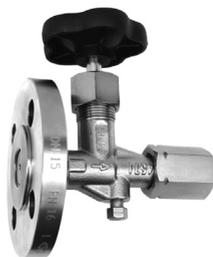
**Клапан запорный игольчатый со сливом КЗИС** – предназначен для подсоединения манометрических приборов к магистрали с рабочей средой, продувки импульсных линий, сброса давления при демонтаже манометра, а также безопасного выпуска среды из зоны манометр-клапан.
