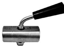
**Кран трёхходовой натяжной КТНр10** - предназначен для присоединения манометра (или датчика давления) к магистрали с рабочей средой, продувки импульсных линий, сброса давления и др.
