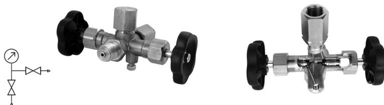
**Клапан запорный игольчатый трёхходовой КЗИТ** - предназначен для подсоединения манометрического прибора к магистрали с рабочей средой, сброса давления и слива среды при демонтаже прибора, а также подключения контрольного манометра с автономным клапаном включения.
