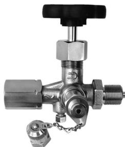
**Клапан запорный игольчатый со штуцером под контрольный манометр КЗИМ** – предназначен для присоединения рабочего и контрольного манометров к магистрали с рабочей средой, сброса давления при снятии манометра, а также слива конденсата из зоны манометр-клапан.
