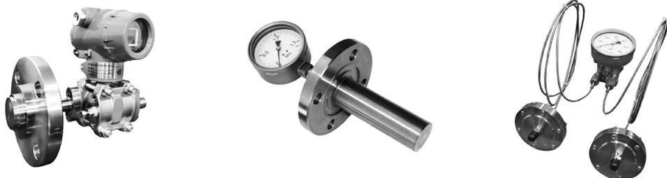
Разделители предназначены для предохранения внутренней полости чувствительных элементов измерительных приборов (манометров и датчиков давления) от попадания в неё агрессивных, кристаллизующихся, содержащих твердые частицы (вкрапления), вязких и других рабочих сред и/или сред с повышенной температурой.
