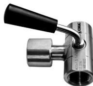
**Кран трёхходовой натяжной со штуцером под контрольный манометр КТНМ10** - предназначен для присоединения рабочего и контрольного манометров (датчиков давления) к магистрали с рабочей средой, сброса давления и отключения в процессе работы.
