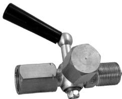
**Кран трёхходовой натяжной со штуцером под контрольный манометр КТНМ** - предназначен для присоединения рабочего и контрольного манометров (или датчика давления) к магистрали с рабочей средой, сброса давления и отключения в процессе работы.
